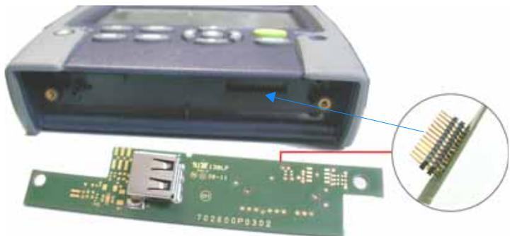
**Abb. 58** Ansicht des Boards und der Steckverbinderleiste
