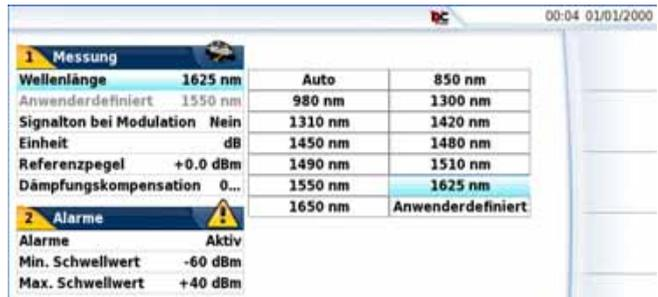
**Abb. 13** Konfiguration der Pegelmessung
