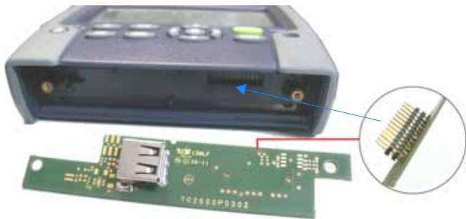
**Abb. 65** Ansicht des Boards und der Steckverbinderleiste
