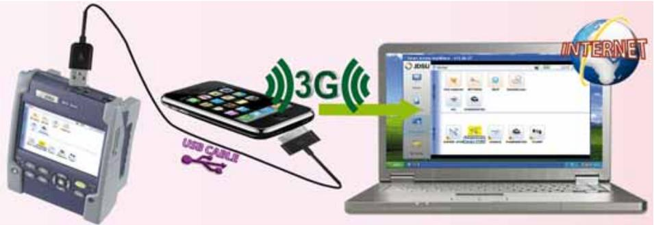
Abb. 45 USB-Verbindung über ein 3G-Smartphone
