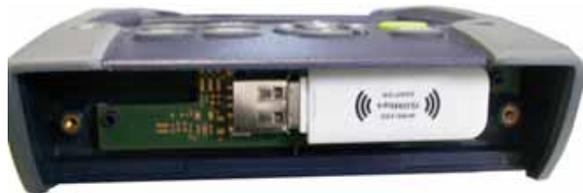
**Abb. 59** WIFI USB-Stick in dem Grundgerät
