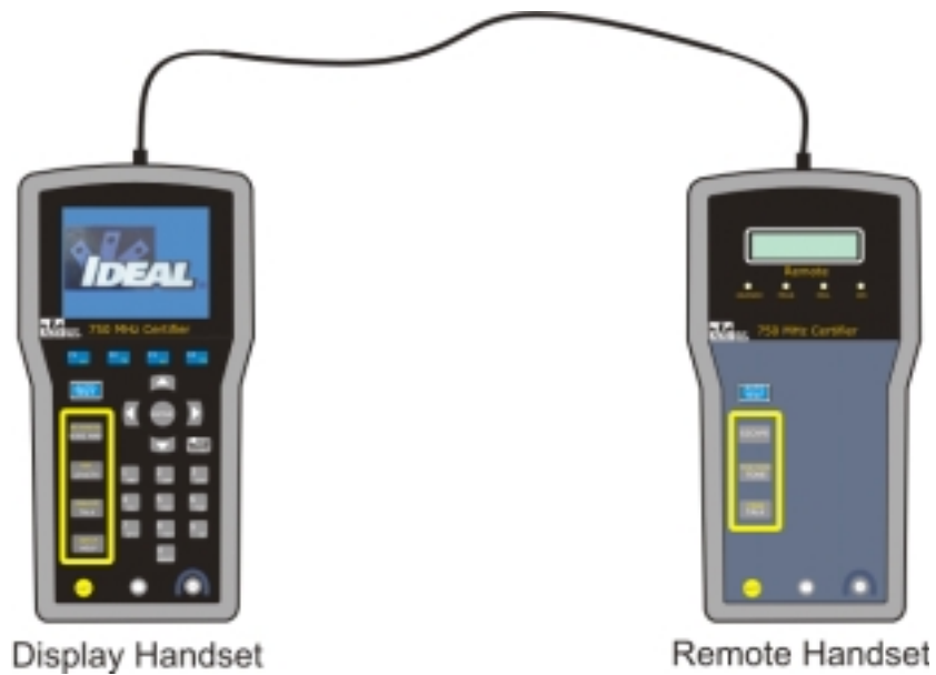
Abbildung 3-3: Aufbau für den Tester-Nullabgleich
