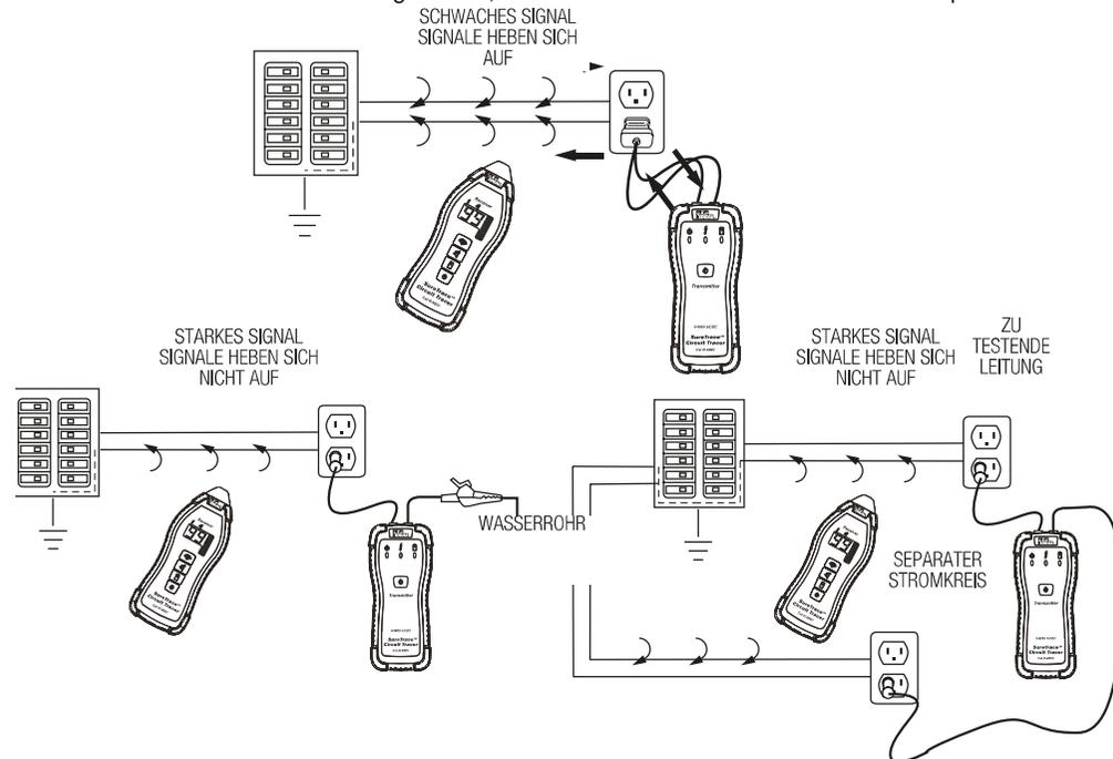
Wenn Sie sich nicht sicher sind, ob die gewählte Rückleitung den Zweck erfüllt, können Sie mit einem Multimeter den Widerstand zwischen dem Nulleiter des Stromkreises und der Rückleitung messen. Wenn der Widerstand  $>100\Omega$  beträgt, sollten Sie eine andere Rückleitung auswählen.
